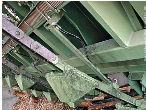
Zentralschmierung am rücklaufenden Kettenstrang eines Vereinzelners
